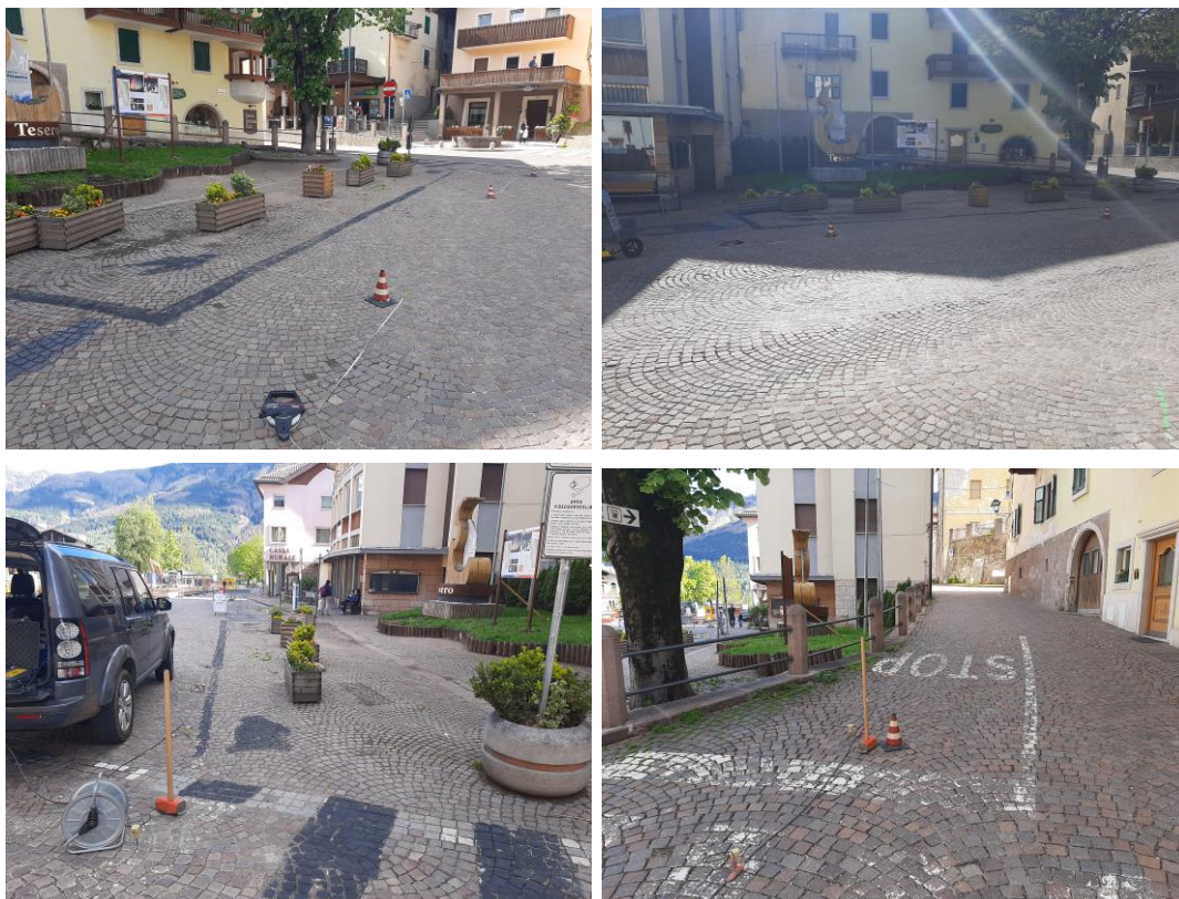
Immagini dell'area georadar ex distributore e degli stendimenti sisici Masw 1 (in basso a sinistra) e del Masw2 (in basso a Destra)
